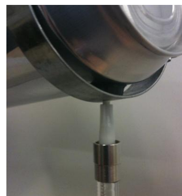
Fig. 3 Inyección de aire en el líquido
