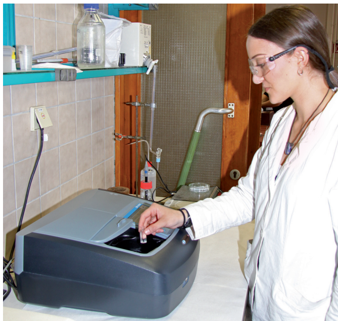
Figura 3: Inserción de la muestra utilizando una cubeta
